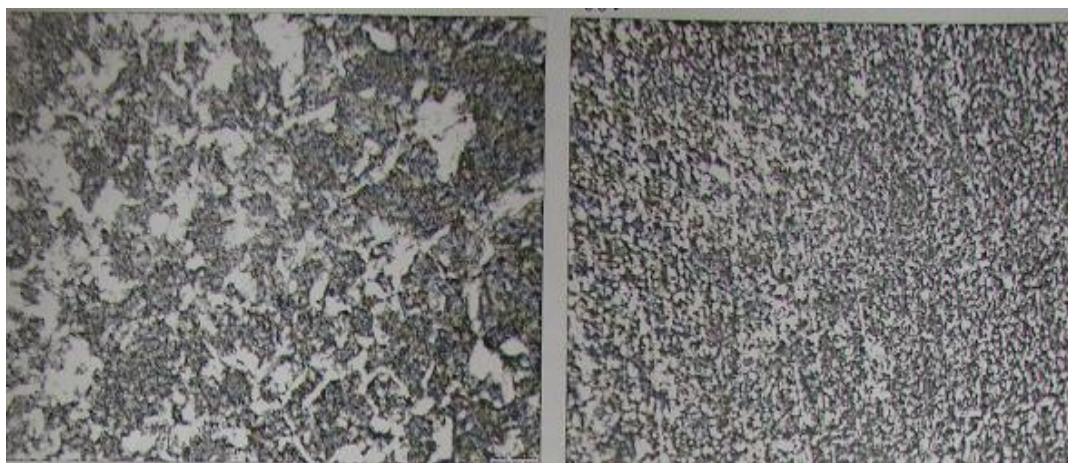
Рисунок 4 – Микроструктура металла колеса
