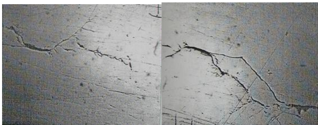
Рисунок 3 – Расслоение металла соединённое трещиной (x100)
