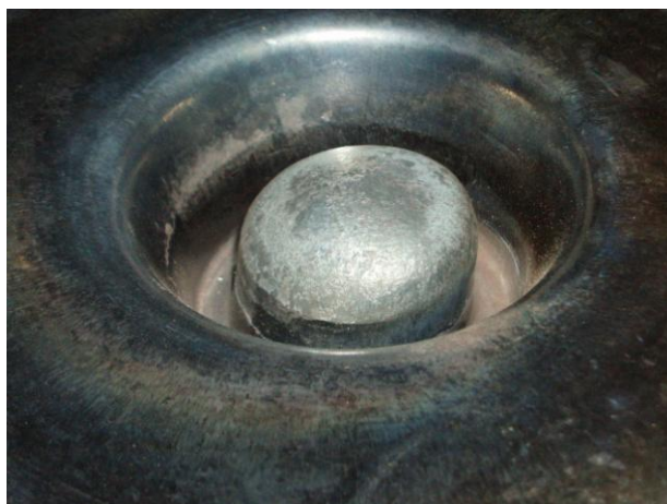
Рисунок 1 – Внешний вид изношенного штампового инструмента
