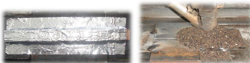
Рисунок 3 – Сборка пластин под сварку
