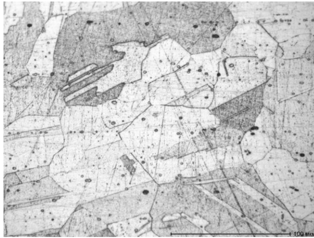
Рисунок 1 – Оптическое изображение исходной структуры меди M006
