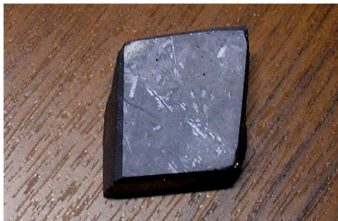
Рисунок 1 – Макроструктура образца кремния перед шлифованием
