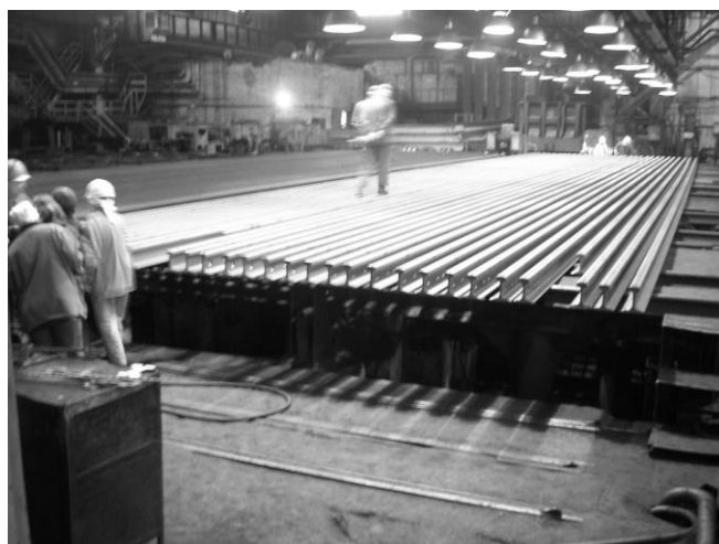
Рисунок 1 – Визуальный контроль качества поверхности рельсов
