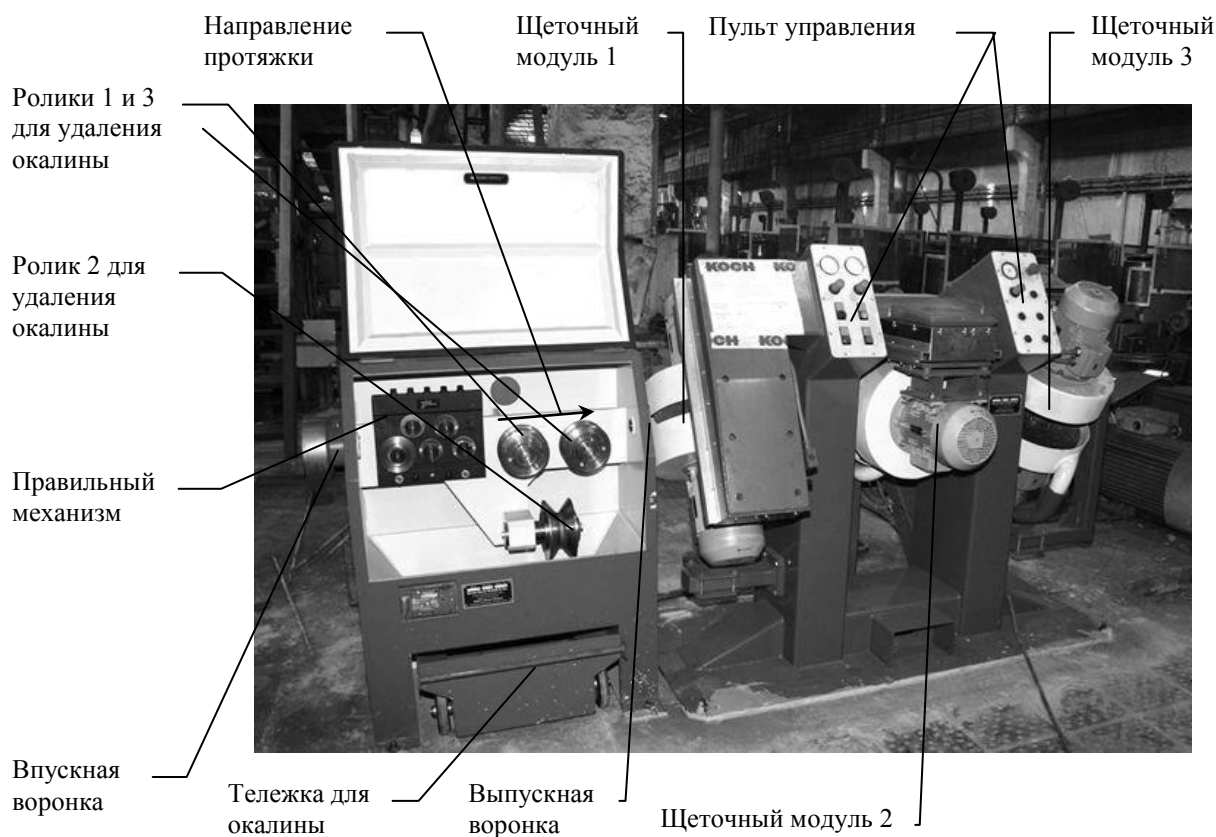
Рисунок 1 – Окалиноломатель типа WEZ1 и щеточная машина для удаления окалины модели RWCB/400-3
