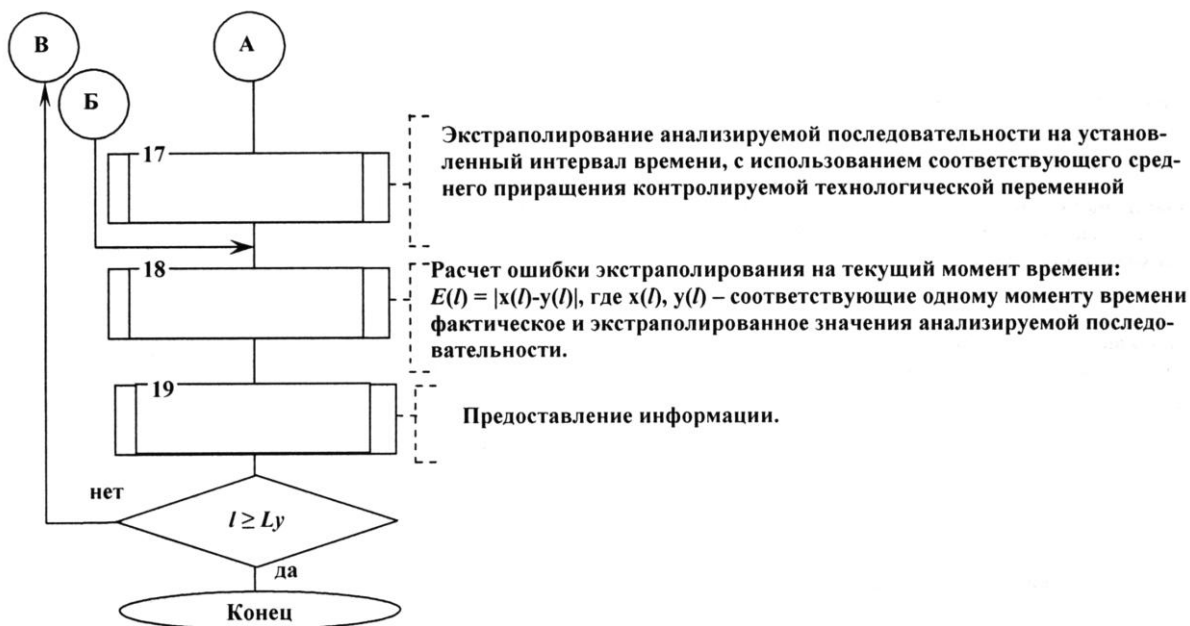
Рисунок 1 – Структурная схема алгоритма экстраполяции нестационарных последовательностей данных с использованием коэффициента сложности
