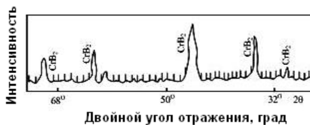
Рисунок 4 – Фрагмент рентгеновской дифрактограммы борида хрома \text{CrB}_2
