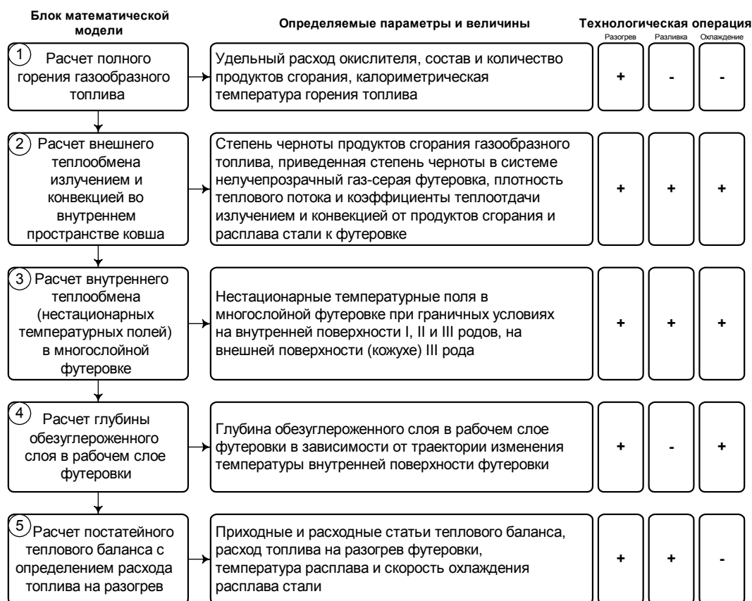
Рисунок 1 – Структура математической модели: + и – используемые и неиспользуемые блоки на соответствующих технологических операциях
