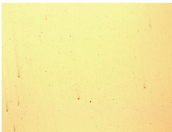
Рисунок 4 – Силикатные и оксидные включения в сварном шве, выполненном под флюсом АН-60 + 6 % добавки, \times 100
