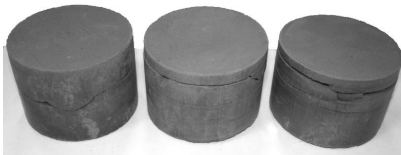
Рисунок 2 – Отпрессованные образцы-цилиндры из обычных пресс-порошков на основе отходов обогащения углистых аргиллитов
