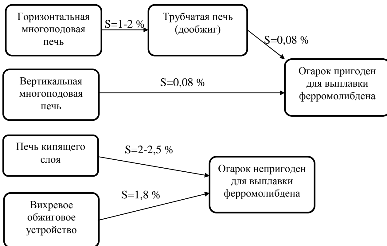
Рисунок 1 – Сравнение технологий обжига молибденовых концентратов
