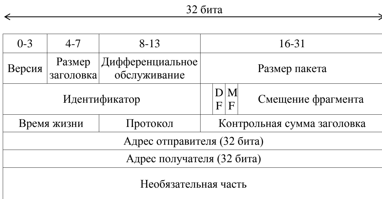
Рисунок 1 — Заголовок IP-дейтаграммы Ipv4
