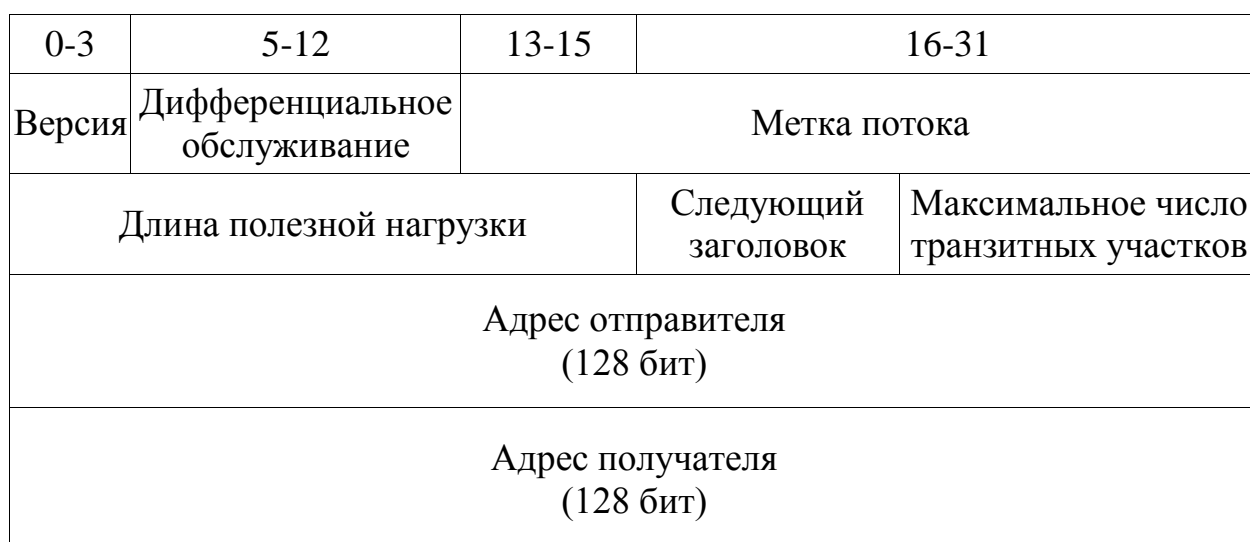
Рисунок 2 — Заголовок IP-дейтаграммы Ipv6
