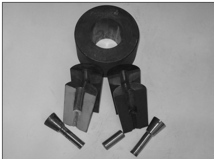
Рисунок 2 – Детали штампа для закрытого выдавливания
