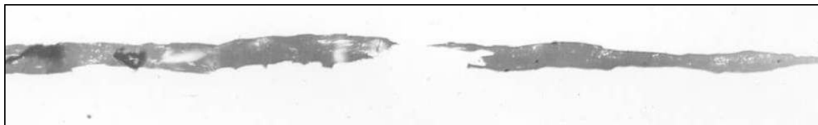
Рисунок 5 – Силикатное включение экзогенного характера, x100
