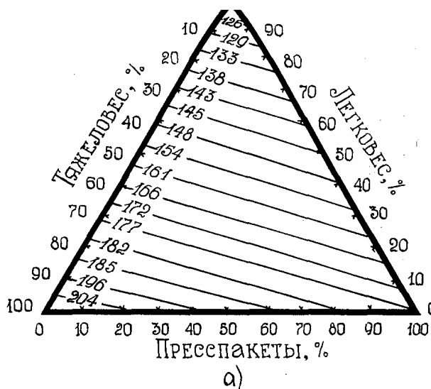
Рисунок 13 – Зависимость среднemasсовой температуры нагрева лома различного состава по истечении 5 мин подогрева порошкообразным углем в вертикально (а) и горизонтально (б) расположенном 160-т конвертере
