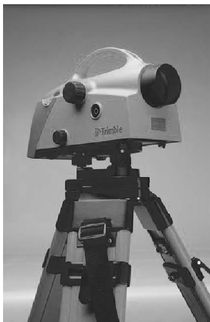
Рисунок 5 – Цифровой нивелир Trimble DiNi
