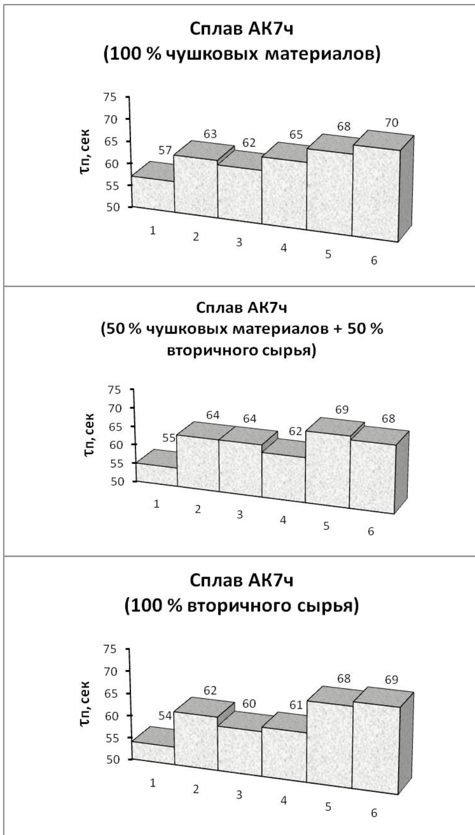
Рисунок 1 – Результаты расчета параметров кристаллизации сплава АК7ч в зависимости от состава шихты и вариантов обработки расплава: 1 – исходный (без обработки); 2 – ТВО; 3 – электрический ток; 4 – магнитное поле; 5 – ТВО и электрический ток; 6 – ТВО и магнитное поле
