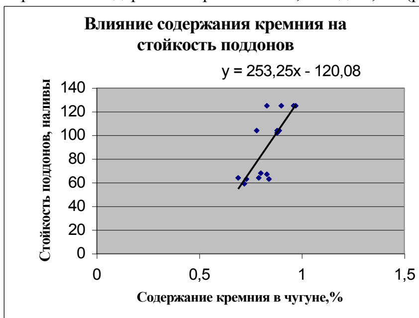
Рисунок 1 – Влияние содержания кремния на стойкость поддонов
