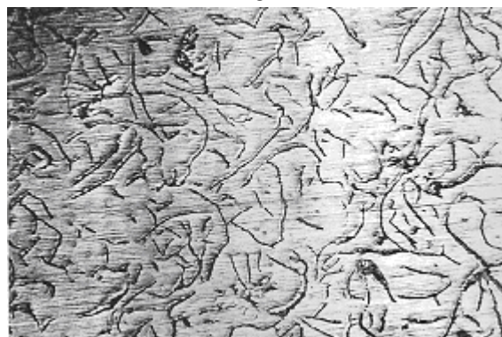
Рисунок 2 – Микроструктура чугуна, продутого азотом с продолжительностью: а – 7,5 мин; б – 13 мин; в – 15 мин, \times 100
