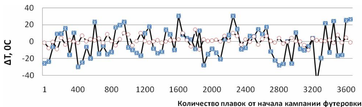
Рисунок 1 – Динамика отклонения \Delta T от заданных значений температуры металла на повалке конвертера №2 ОАО «Северсталь»:
