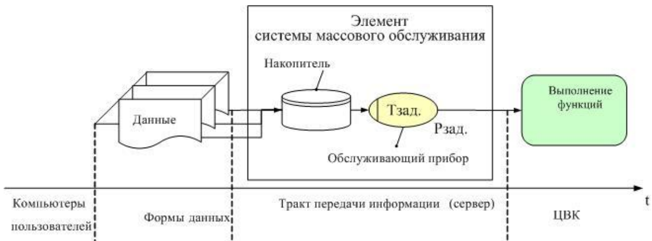
Рисунок 6 – Схема модели системы массового обслуживания с ожиданием
