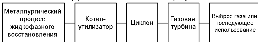
Рисунок 3 – Графическое изображение схемы энергоутилизации отходящих газов
