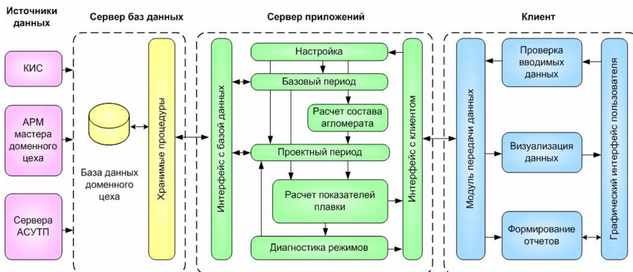
Рисунок 2 – Архитектура информационно-моделирующей системы выбора состава железорудных компонентов шихт в аглодоменном производстве
