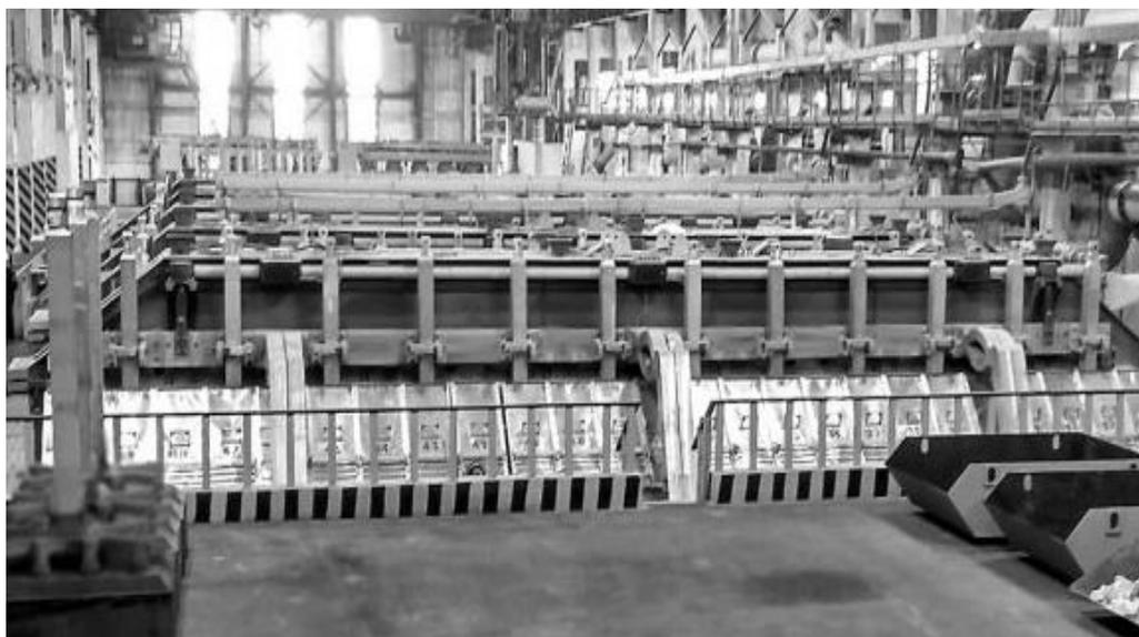
Рисунок 1 – Внешний вид электролизера на силу тока 550кА
