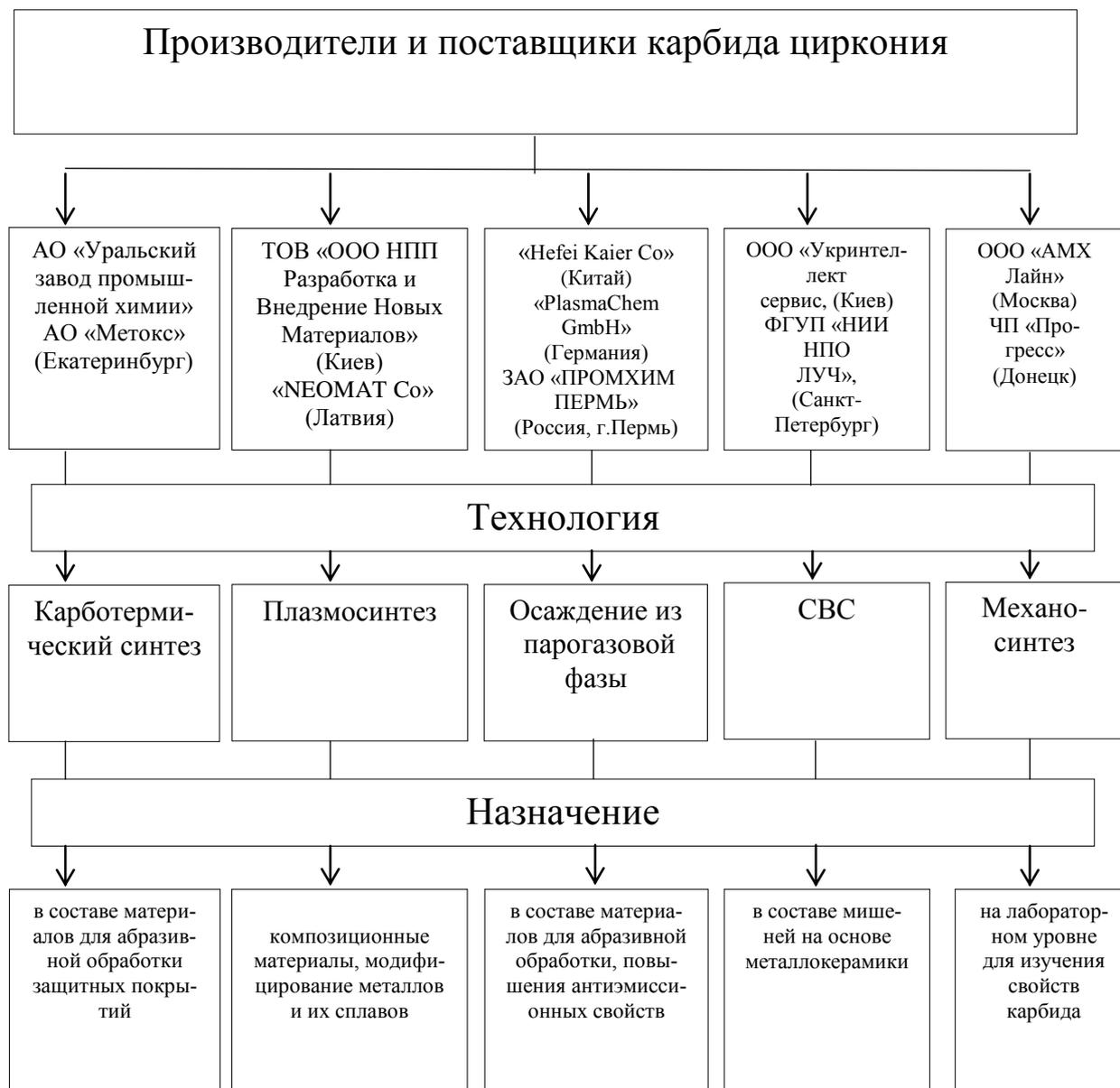
Рисунок 1 – Информация о производителях карбида циркония, реализуемых ими технологических вариантах его получения и основных областях применения
