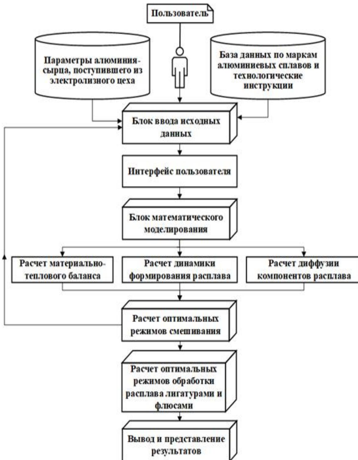
Рисунок 1 - Блок-схема АИС «Алюминцик»
