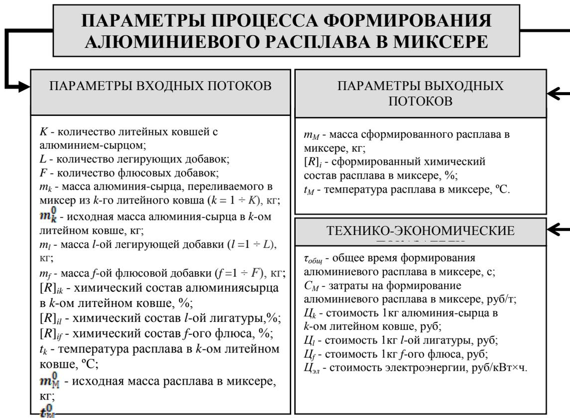
Рисунок 2 – Параметры процесса формирования алюминиевого расплава в миксере
