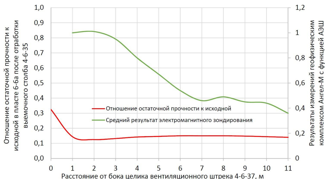
Рис. 11. Графики изменения вычисленных и измеренных геомеханических параметров после отработки выемочного столба 4-6-35
