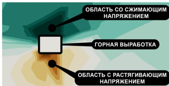
Рисунок 1 – Визуализация напряжений горного массива вокруг исследуемой выработки
