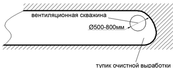
Рисунок 3 – Сквжина большого сечения, пробуренная в очистном забое
