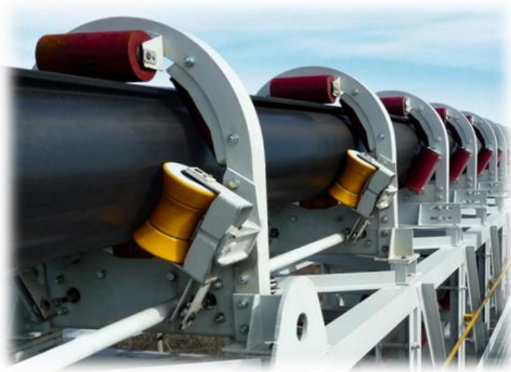
Рисунок 2 – Трубчатый ленточный конвейер
