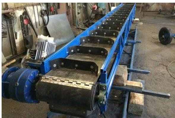
Рисунок 3 – Скребокный конвейер [3]
