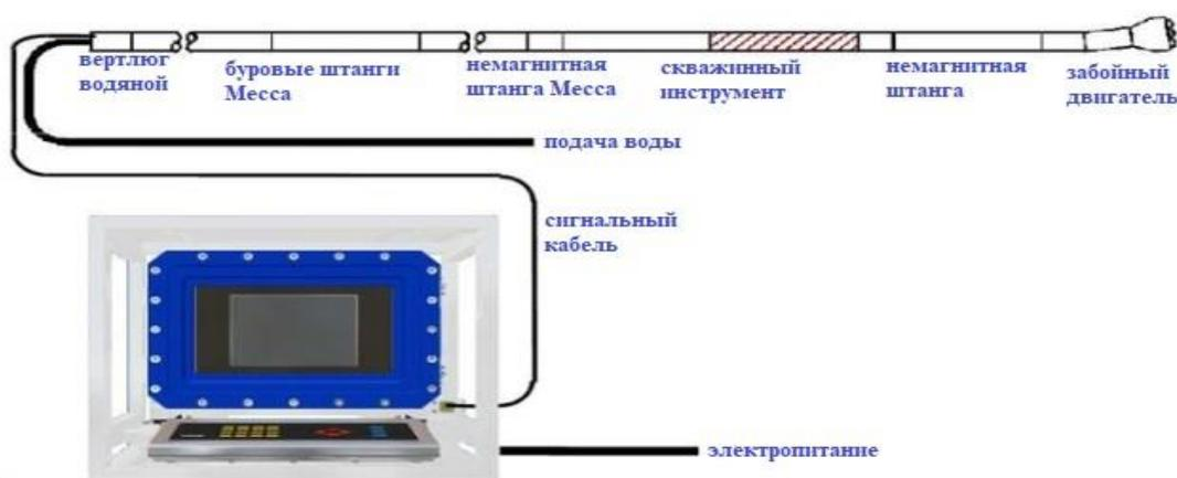
Рисунок 1 – Компоненты системы направленного бурения [2]
