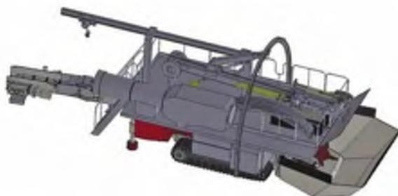
Рис. 1. Самоходный бункер-перегрузатель [1]
