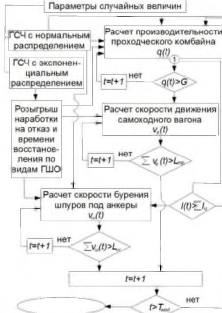
Рис. 2. Укрупненная блок-схема имитационной модели подготовительного забоя
