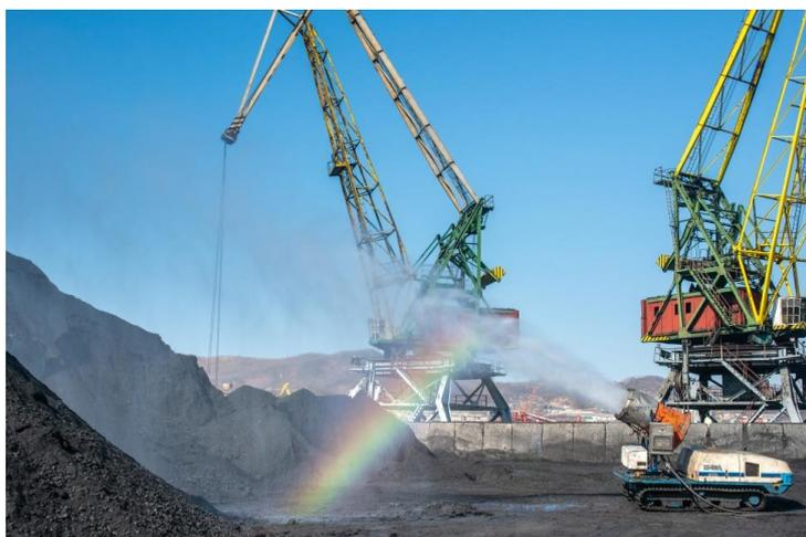
Рисунок 3 – Оросительная установка на угольном разрезе
