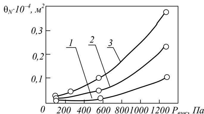
Рис. 4. Зависимость относительного количества структурных углублений напыленного слоя шихты от давления ВПС; уравнения регрессии для различной влажности шихты: 1 –  $W_{ш} = 5,5\%$  ( $y = 0,0237e^{0,0023x}$ ,  $R^2 = 0,9921$ ,  $y = \theta_N \cdot 10^{-4}$ ,  $x = P_{впс}$ ); 2 –  $W_{ш} = 7,5\%$  ( $y = 0,0163e^{0,0022x}$ ,  $R^2 = 0,9996$ ); 3 –  $W_{ш} = 9,5\%$  ( $y = 0,0079e^{0,002x}$ ,  $R^2 = 0,9801$ )
