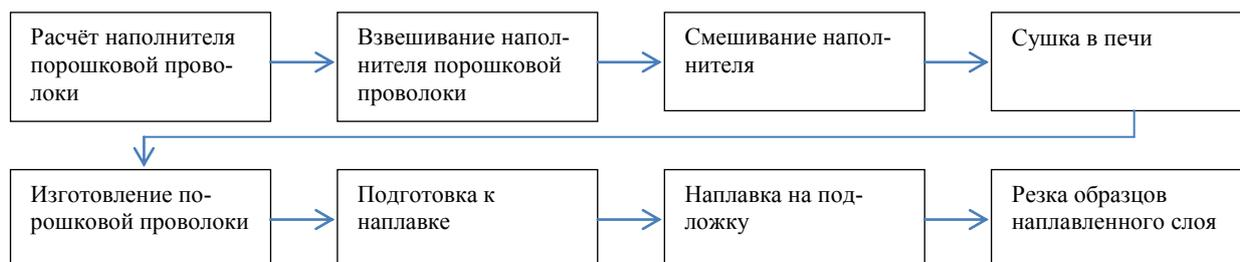
Рисунок 1 - Блок схема процесса изготовления порошковой проволоки
