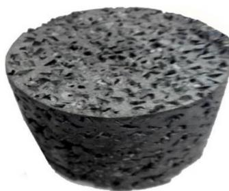
Рисунок 2 - Пористая заготовка-преформа из матричного алюминиевого сплава для ввода в поры частиц малого размера, в том числе наноразмерных
