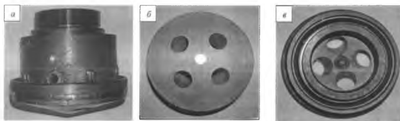
Рисунок 4 – Цельноточенный четырехсопловый наконечник к двухъярусной фурме
