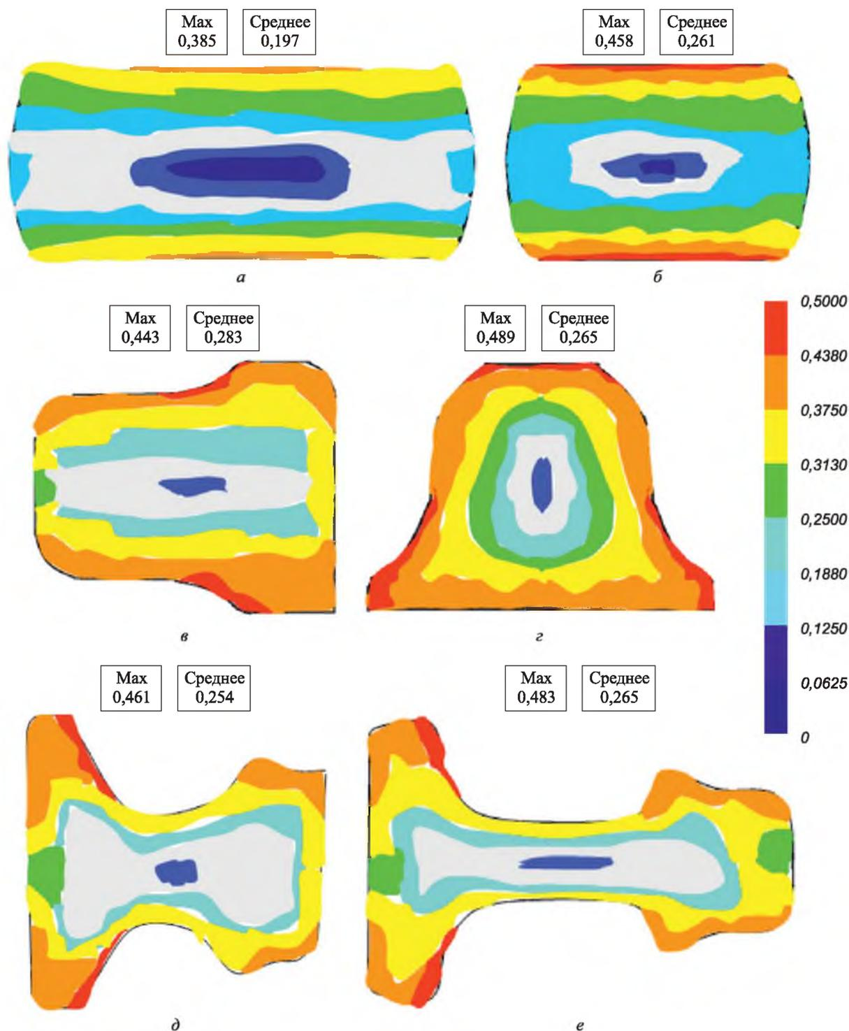
Рис. 3. Распределение критерия Кокрофта-Лэтгэма в поперечном сечении раската на начальной стадии прокатки рельсов: а, б и в – второй, шестой и седьмой проходы в черновой клети 1; г, д и е – первый, третий и пятый проходы в черновой клети 2
