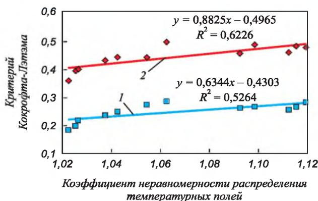
Рис. 4. Зависимость схемы НДС металла от неравномерности распределения температур по сечению раската при прокатке в черновых клетях универсального рельсобалочного стана: 1 и 2 – средние и максимальные по сечению значения критерия
