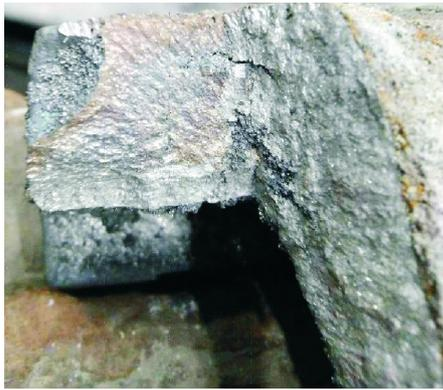
**Рис. 6.** Дефекты в узлах сопряжения в секции газосборного колокола (место отбора пробы № 1)
