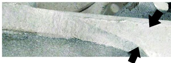
**Рис. 4.** Макроструктура излома нижней части секции газосборного колокола (место отбора пробы № 3)
