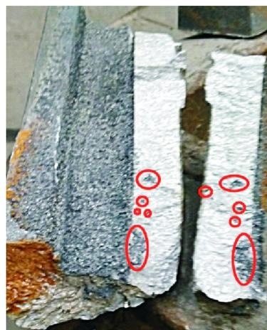
**Рис. 5.** Внутренние дефекты в верхней части секции газосборного колокола (место отбора пробы № 2)
