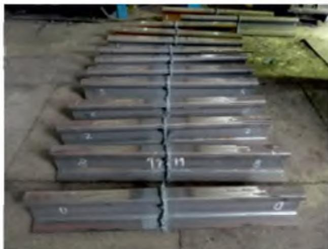
Рис. 2. Общий вид полнопрофильных образцов после сварки
