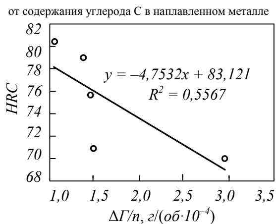
Рис. 3. Зависимость скорости истирания ( \Delta Г/n ) от твердости образцов (HRC)
