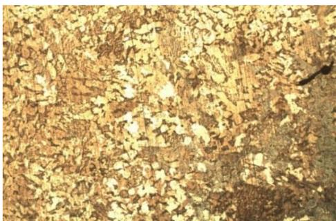
Рисунок 4 – Образец 2 после травления при увеличении x100
