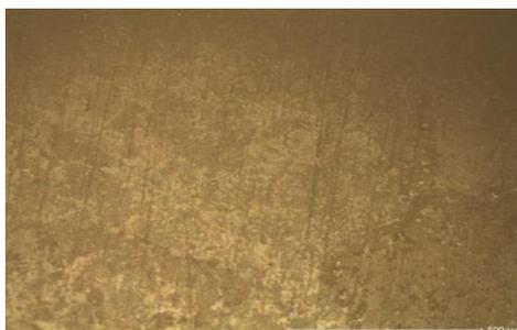
Рисунок 6 – Образец 3 после травления при увеличении x100
