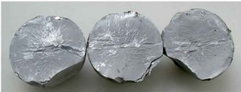
Рис. 3. Флокены в изломе шаров после испытаний на ударную стойкость
