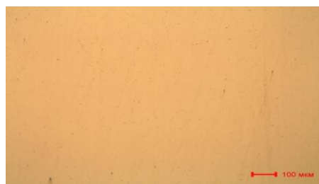
Рисунок 1 – Структура наплавленных образцов, \times 500
