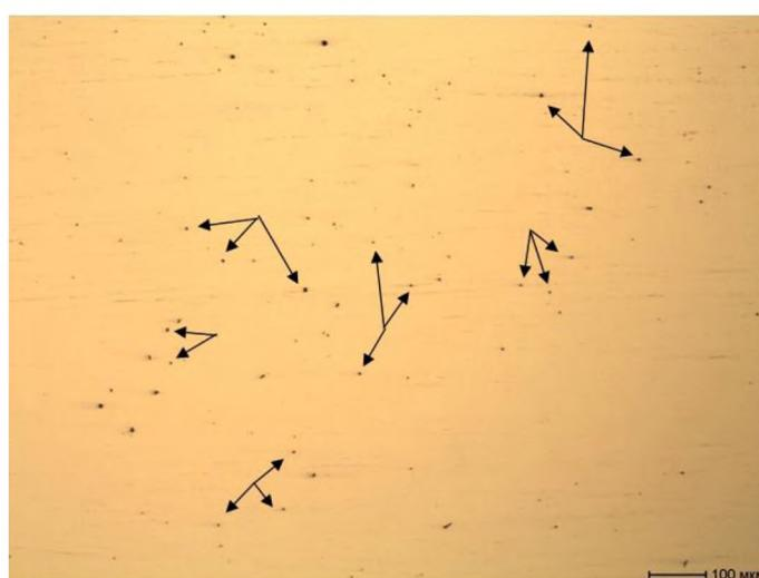
Рисунок 2 – Характерные неметаллические включения в непрерывнолитых заготовках стали Зсп
