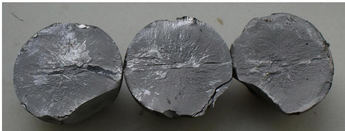
Рисунок 2 – Флокены в изломе мелюющих шаров из рельсовой стали К76Ф
