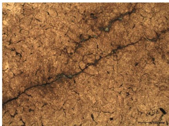
Рисунок 4 – Микротрещина по границам зерен в шаре из рельсовой стали К76Ф, не выдержавшем испытание на ударную стойкость
