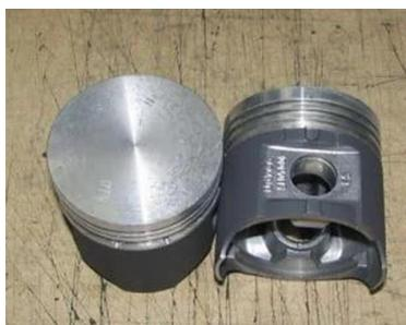
Рисунок 1 – Общий вид поршня двигателя ЗМЗ-672
