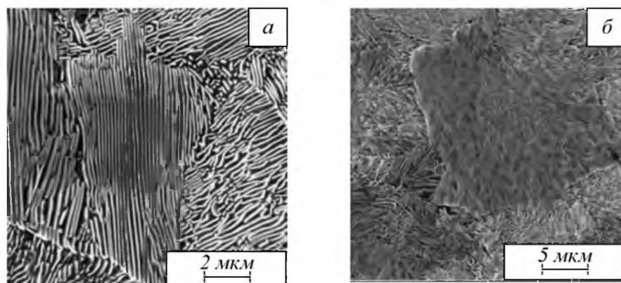
Рис. 4. Микроструктура металла рельсов заэвтектоидной группы состава 3
