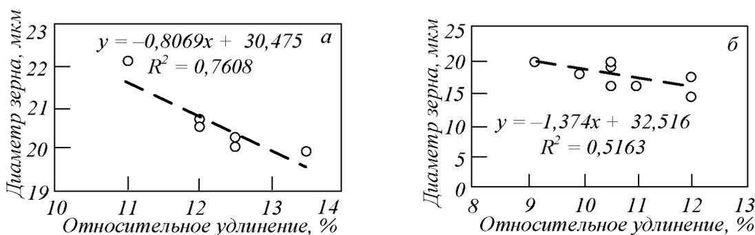
Рис. 10. Зависимости относительного удлинения от диаметра зерна:
