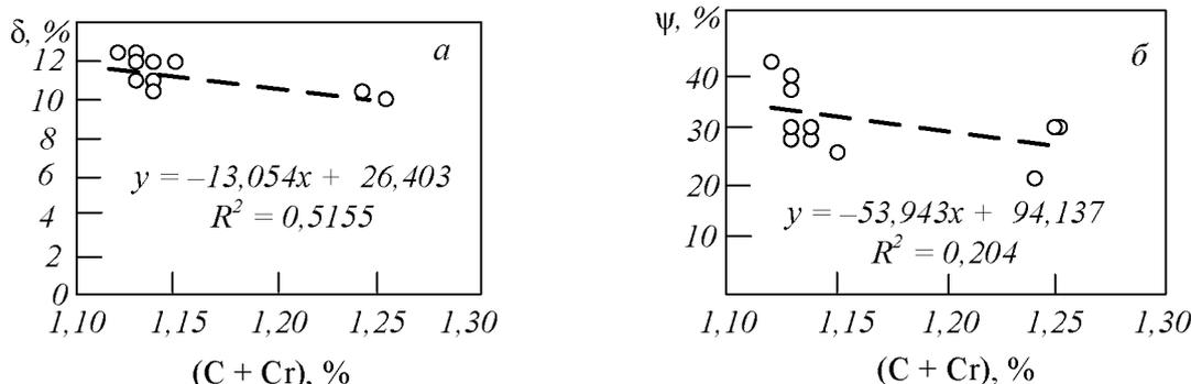
Рис. 8. Зависимости относительного удлинения (а) и относительного сужения (б) от суммарного содержания углерода и хрома
