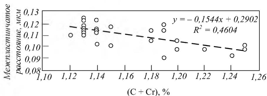
Рис. 1. Зависимость межпластинчатого расстояния от суммарного содержания в стали углерода и хрома
