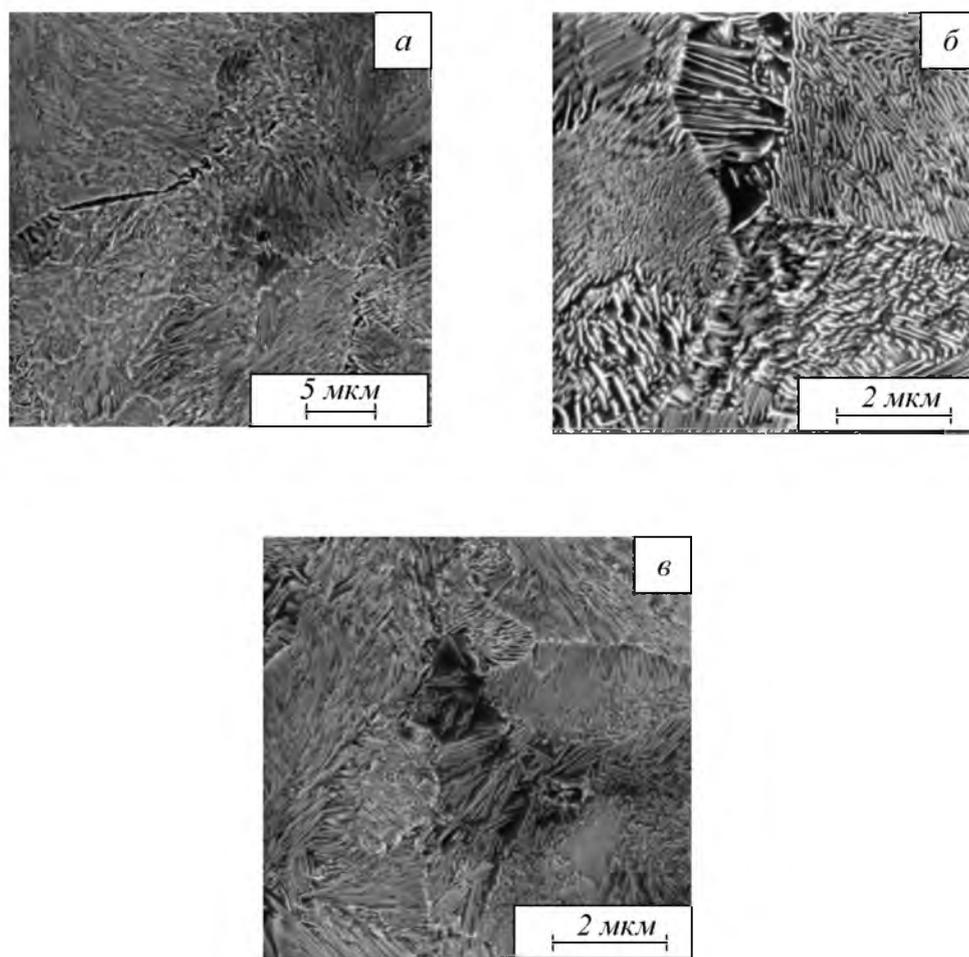
Рис. 6. Микроструктура металла рельсов заэвтектоидной группы состава 3
