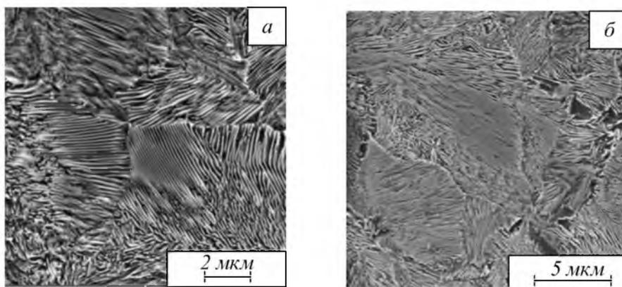
Рис. 3. Микроструктура металла рельсов эвтектоидной группы состава 1
