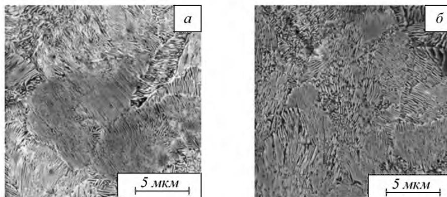
Рис. 2. Микроструктура металла рельсов эвтектоидной группы состава 2
