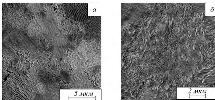
Рис. 5. Микроструктура металла рельсов заэвтектоидной группы состава 4
