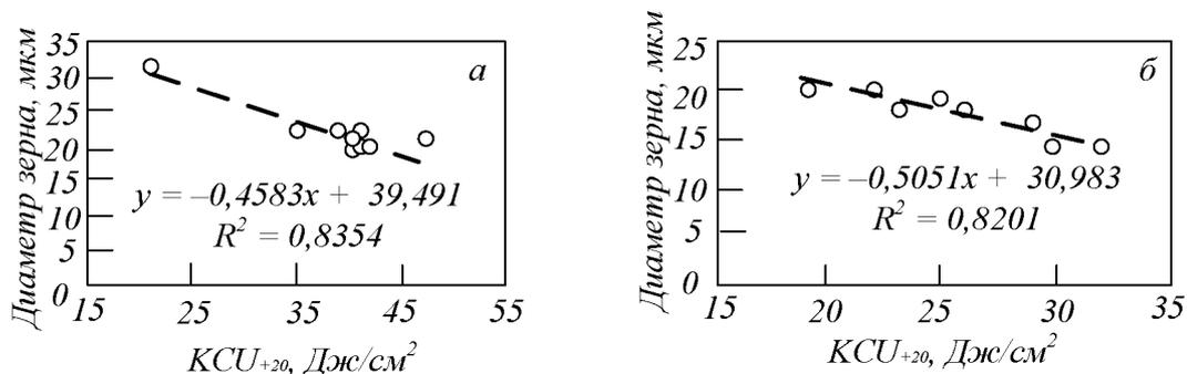
Рис. 9. Зависимости ударной вязкости от диаметра зерна:
