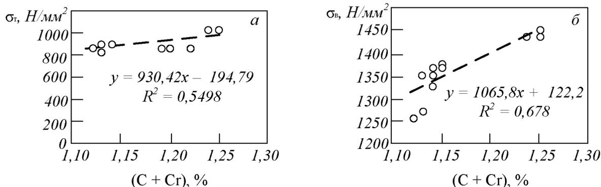
Рис. 7. Зависимости предела текучести (а) и временного сопротивления (б) от суммарного содержания углерода и хрома
