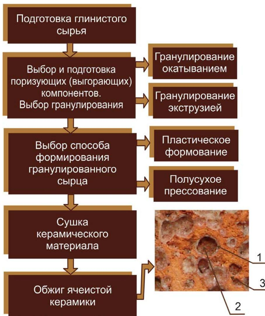
**Рисунок – Блок-схема формирования эффективной керамики:**
