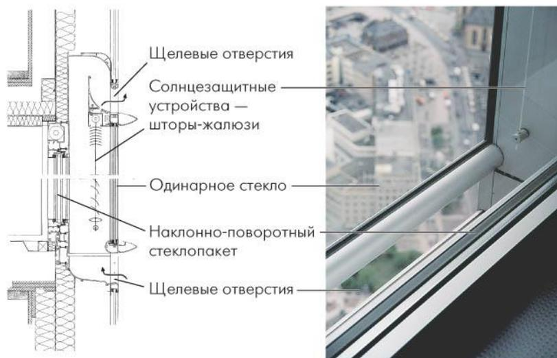
Рисунок 4 - Двухслойный вентилируемый фасад
