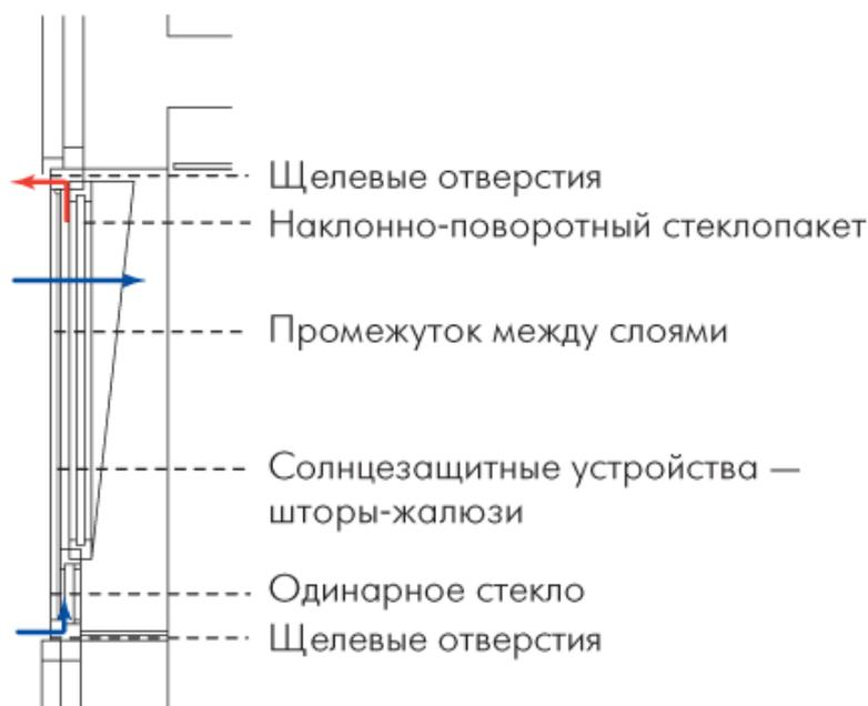
Рисунок 3 - Вариант двухслойного вентилируемого фасада со щелевыми отверстиями
