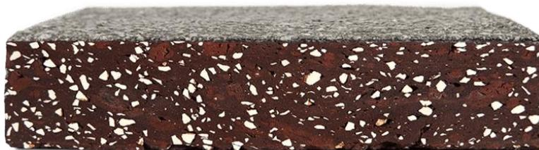
Рисунок 2 - Truffle («Трюфель»), цвет – черно-коричневый, текстура – гладкая, на 60 процентов изготовлен из отходов;
