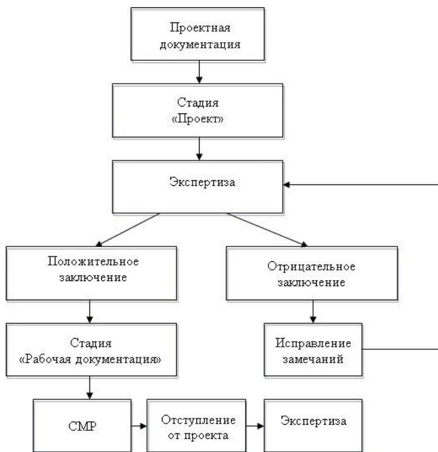
Рисунок 1 - Схема экспертизы проектной документации
