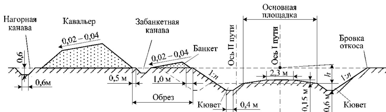
Рисунок 6 – Поперечный профиль земляного полотна железнодорожного пути
