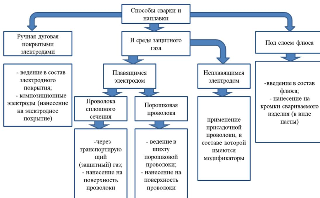
Рисунок 1 – Схема применения нано- и ультрадисперсных порошков в соединительных технологиях
