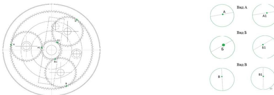
Рисунок 3 – Анализ контакта зацепления зубчатых колес при работе планетарного механизма с уникальным водило
