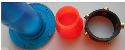
с целью замены металлических деталей на полиэтиленовые, с последующим изготовлением их на 3-д принтере.
