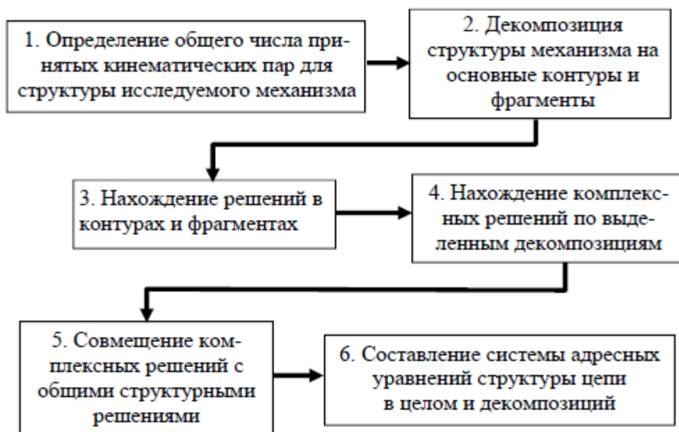
Рис. 2. Алгоритм исключения избыточных связей в шарнирных механизмах
