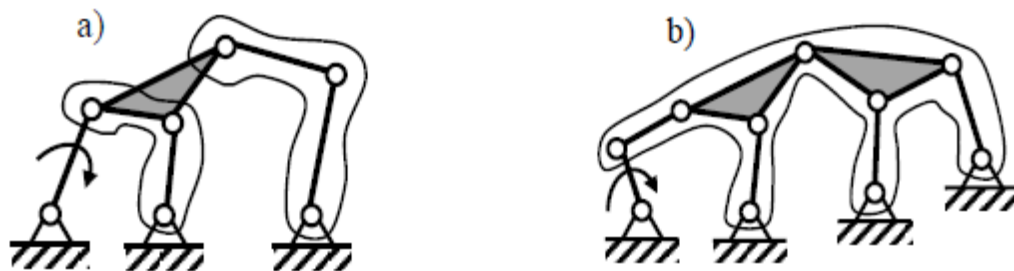
Рис. 1. Механизмы третьего семейства, шестизвенный (а), восьмизвенный (б)
