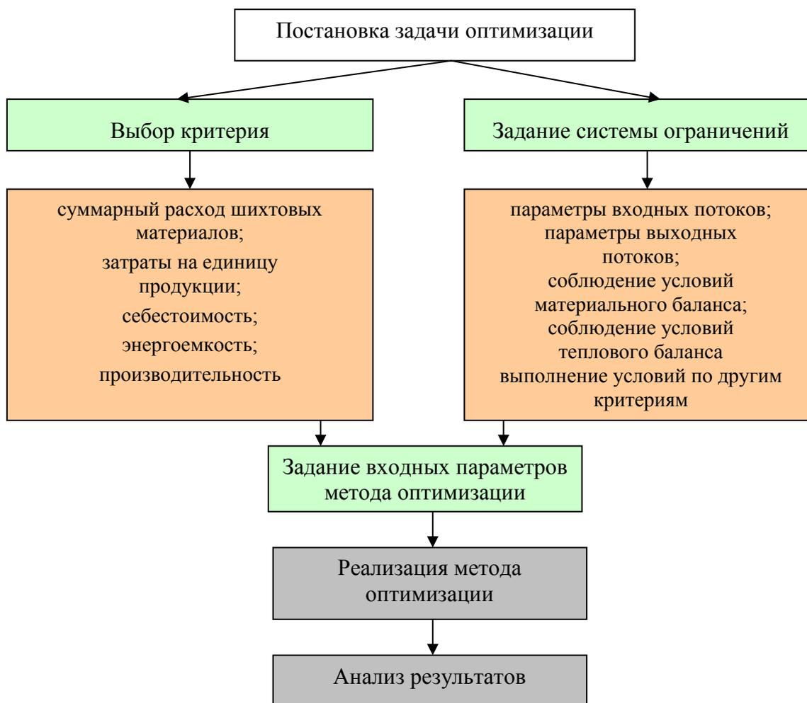
Рисунок 4 – Схема решения оптимизационной задачи
