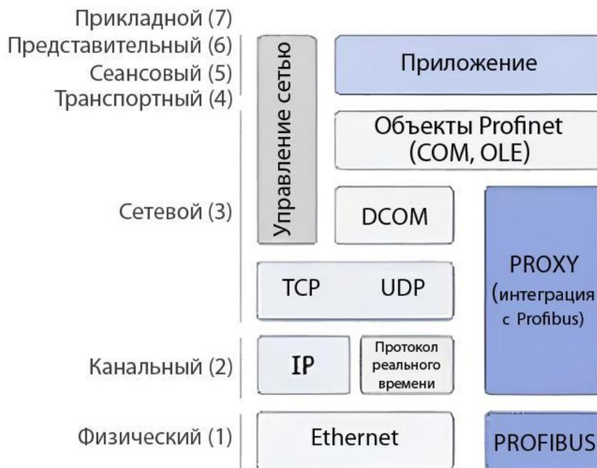
Рис. 1. Структура протокола Profinet по модели OSI
