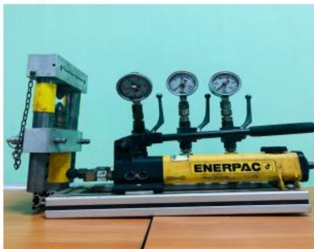
Рисунок 3 – Прибор для испытания пород точечной нагрузкой (Поинт-Лoad-Тест)
