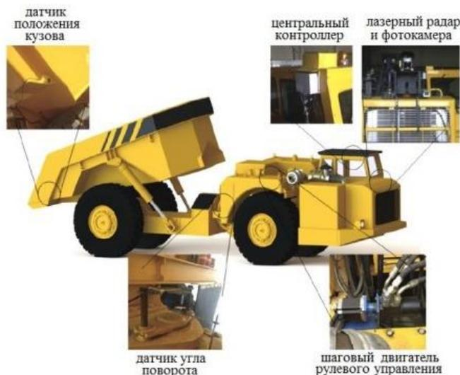
Рисунок 1 – Распределение датчиков для беспилотного вождения [5]
